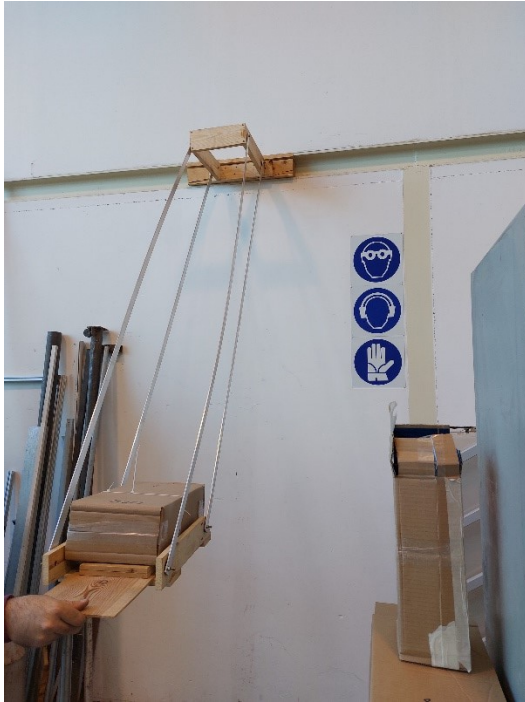
Test di urto orizzontale
